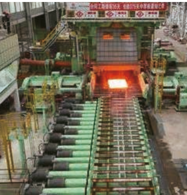
陕西省汉中市 陕钢集团汉中钢铁有限公司 3500mm四辊可逆轧机
