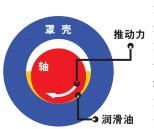
润滑油薄膜面积也会增大,使得摩擦进一步减少。当两个接触表面因为润滑油的作用而完全分离时,摩擦也就减少到最低,如果转动速度继续增加,摩擦又会重新加大,因为那时润滑油所形成的薄膜继续增多,会产生粘性阻力。
