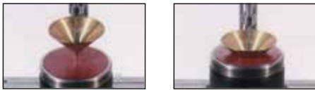
图2：沉入润滑脂中的针入度计圆锥体
