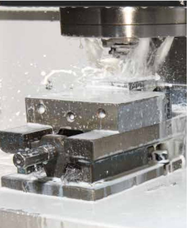
导轨油和切削液保持良好可分离性，可降低细菌繁殖风险，防止异味产生；减少导轨油乳化现象，减轻对环境的影响；同时减少设备因故障而意外停工，降低生产成本，有助于机械加工实现理想精度，带来高效生产。
