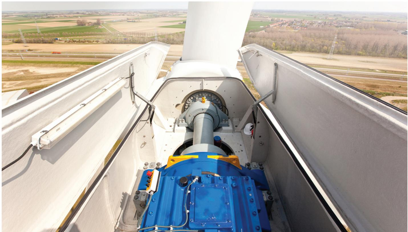
14. 循环冲洗油并运行空载的涡轮机，直至油温至少达到60°C/140°F。(如果在负载条件下运行涡轮机可行，则可以接受)。根据污染程度进行冲洗，至少冲洗一小时。如果运行空载的涡轮机不切合实际，请使用主润滑油泵来循环润滑油。记录冲洗过程的持续时间和温度。监控齿轮箱是否存在温度异常和过滤器堵塞，如有必要请记录。确保现场可提供备用过滤器。
